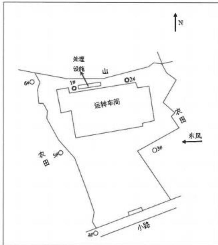
◎—有组织废气监测点位；○—无组织废气监测点位
