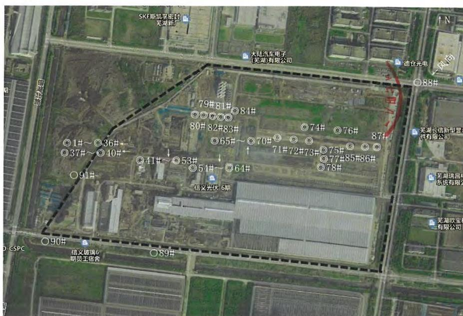
◎-有组织废气采样点；○-无组织废气采样点
