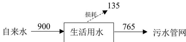
图 2-1 项目水平衡图 单位：t/a
